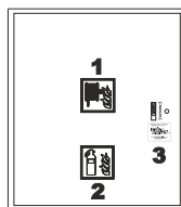
Prawidłowe oznaczenie hydrantu
