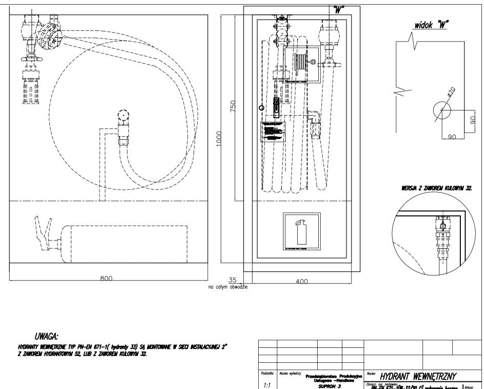
Oznacz, rys. zestawien. PH-EN 671-1/W-33/20 GJ wykonanie boczne 1 PN-EN 671-1/W-33/30 GJ wykonanie boczne 1
